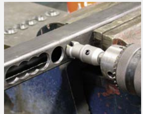
Bohren in Quadratprofil
