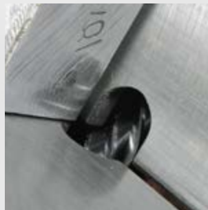
Exaktes Entgraten durch Abwälzfräsen
