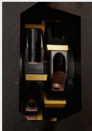
2 Frässcheiben gekoppelt mit je 6 Wendeplatten
