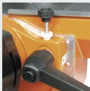
Feinjustierung der Frästiefe/Fasenbreite
